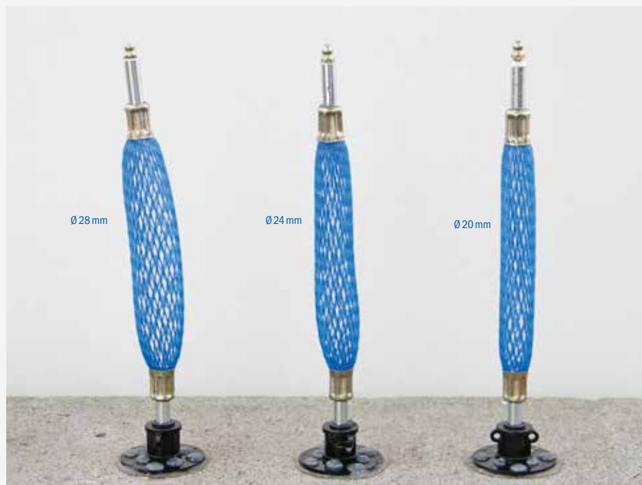
Druckvorratsschlauch mit Klebepacker gesetzt; (von links) Ø 28 mm – ca. 5 bar, Ø 24 mm – ca. 2 bar, Ø 20 mm – ca. 1,5 bar Self-injecting hose with adhesive packer placed; (from the left) Ø 28 mm – 5 bar, Ø 24 mm – 2 bar, Ø 20 mm – 1.5 bar
